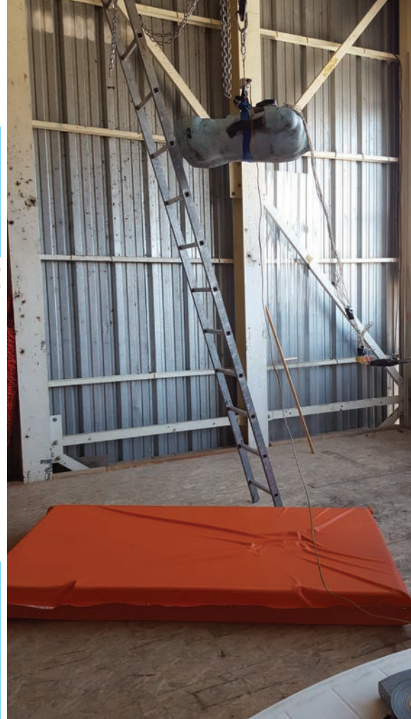
Cinématique de skieur lors d'une collision contre un obstacle protégé par un matelas Essai grandeur nature d'un lâcher de torse en résine sur un matelas
